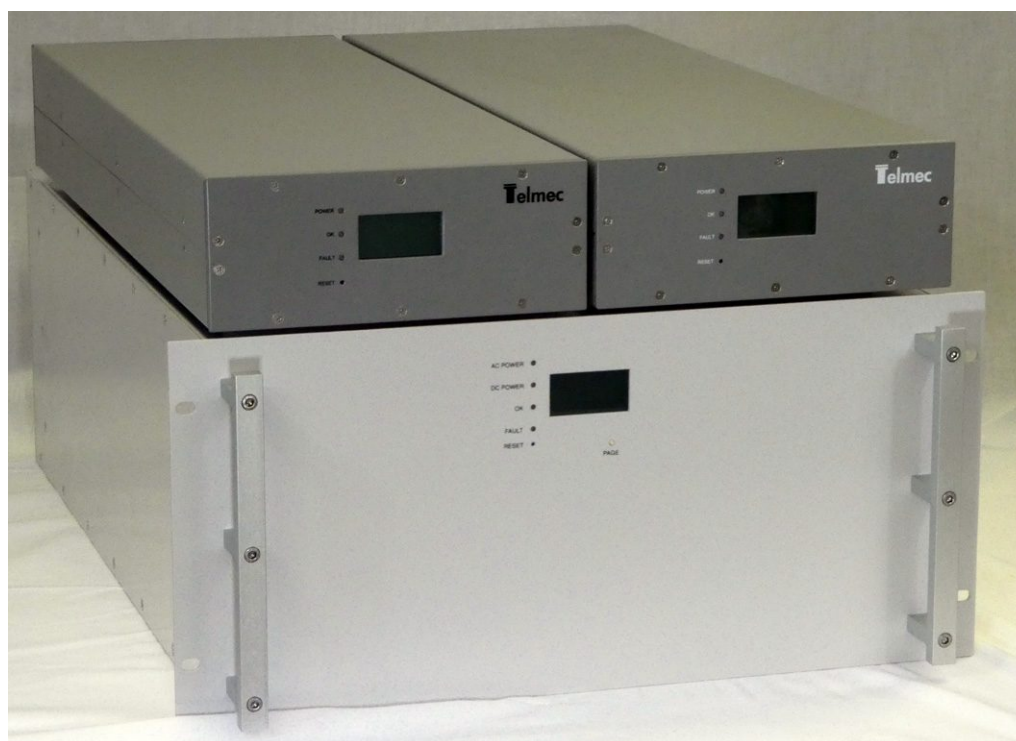
La figura mostra il nuovo filtro a sintonia automatica realizzato nel corso del progetto Small Tune (sopra) a confronto con il filtro precedentemente prodotto da Telmecc (sotto). Come si vede il nuovo filtro ha altezza inferiore alla metà del precedente e larghezza metà (come si vede possono essere alloggiati due filtri del nuovo tipo nella stessa larghezza).
